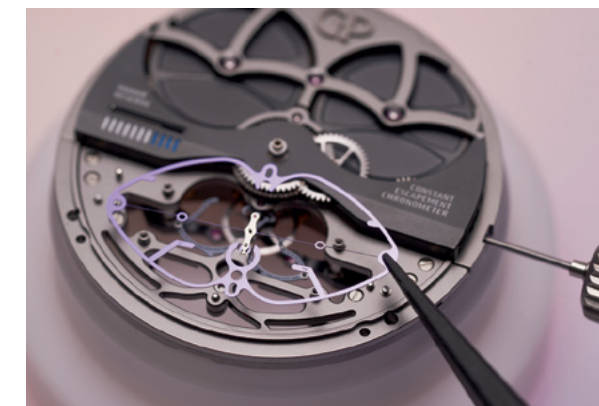
CON 13 PATENTES El escape, el mecanismo que controla el «fluir del tiempo», ofrece un diseño único basado en las propiedades elásticas y biestables de la lámina de pandeo de silicio.
